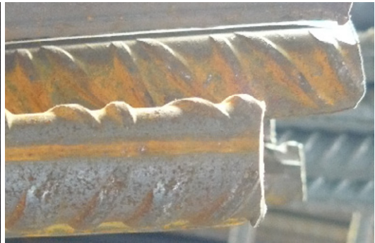
Bild 3.16 Seitenansicht einer gehackten Schneidefläche, die relativ gerade und rechtwinklig ist
