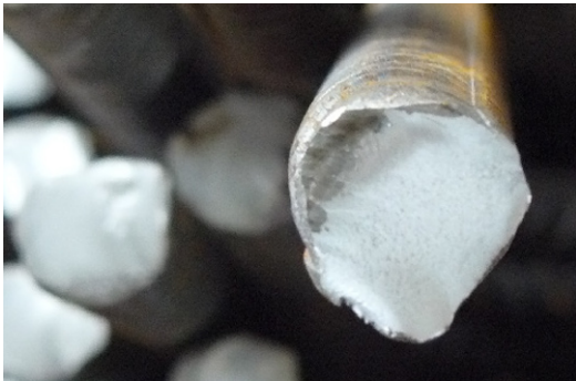
Bild 3.15 Vorderansicht einer gehackten Schneidefläche mit Kerb- und Bruchzone
