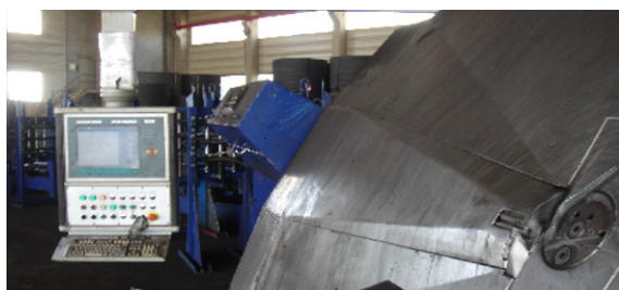
Bild 4.32 Coilablauf, Richtvorrichtung, Biegevorrichtung bis zum Biegeteller in einer Richtung
