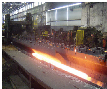
Bild 3.2 Der Beginn des Auswalzens der Bramme oder des Knüppels zum Betonrundstahl bei ca. 1300 °C
