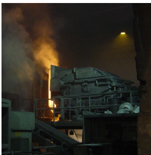
Bild 3.1 Die Stahlerzeugung mit dem Einfüllen von Zuschlägen am Elektroschmelzofen
