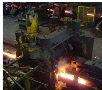
Bild 3.3 Eine Walzvorrichtung in der Walzstraße zur Herstellung von Betonrundstahl
