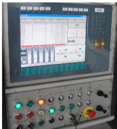
Bild 4.30 Steuercomputer mit dem Bildschirm und der Tastatur in Touchscreen-format seitlich daneben
