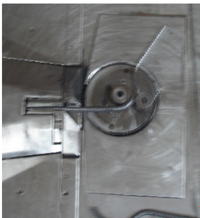
Bild 4.31 Biegeteller mit Biegedorn genau mittig und Stabdurch-Biegemitnehmerrolle seitlich rechts
