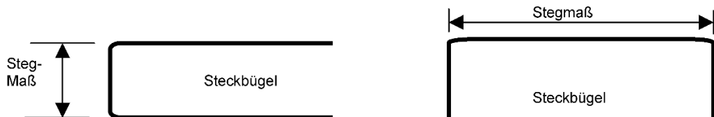
Bild 4.19 „Steckbügel“ mit seinem „Stegmaß“ in zwei Varianten
