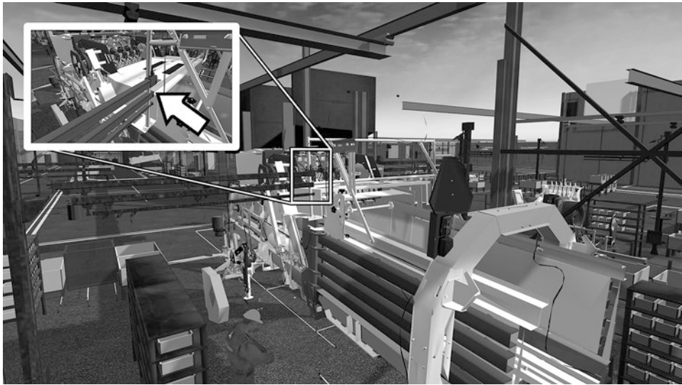
Abb. 26.2 Beispiel einer Kollisionsprüfung im IVR-Modell
