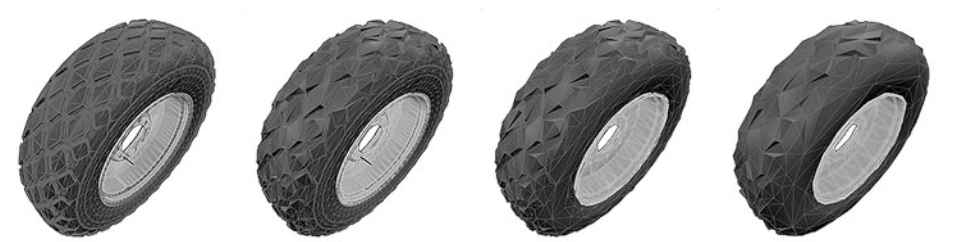
Abb. 26.5 Durch Vereinfachung generierte Detaillevel einer Produktkomponente
