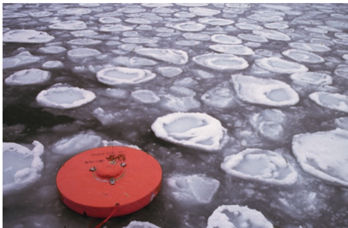
Abb. 11.4 Dünnere, jüngere Pannkucheneis werden mit einer Wellenboje untersucht
