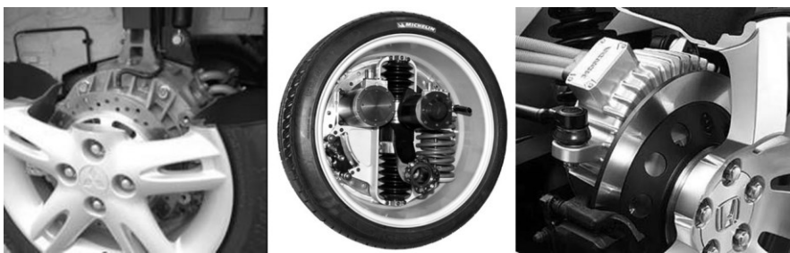
Bild 212 Radnabenmotoren für Fahrzeugantrieb: Mitsubishi (links), Michelin (Mitte), Honda (rechts) (Quellen: Mitsubishi, Michelin, Honda)
