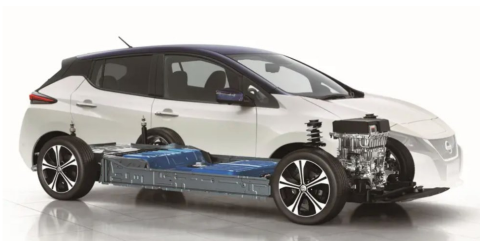
Bild 19 Fahrzeug mit Elektromotor-Antrieb und elektrischem Energiespeicher (Batterie) (Quelle: Nissan)
