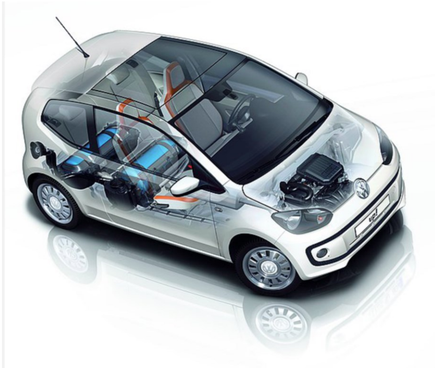
Bild 139 Konfiguration der CNG-Tanks in einem sehr kompakten Fahrzeug: VW Up (Quelle: VW)
