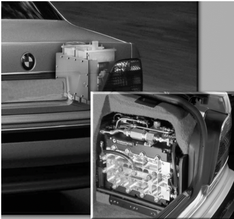
Bild 162 Wasserstoffbetriebene Brennstoffzelle zur Stromerzeugung an Bord eines Automobils mit Wasserstoff-Ottomotorantrieb (Quelle: BMW)
