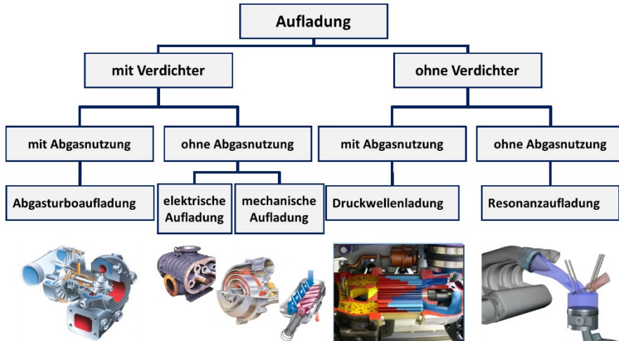
Bild 42 Aufladeverfahren für Kolbenmotoren
