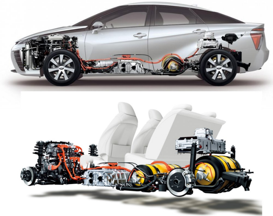
Bild 190 Automobil mit Elektromotorantrieb auf Basis einer wasserstoffbetriebenen Brennstoffzelle (Quelle: Toyota)
