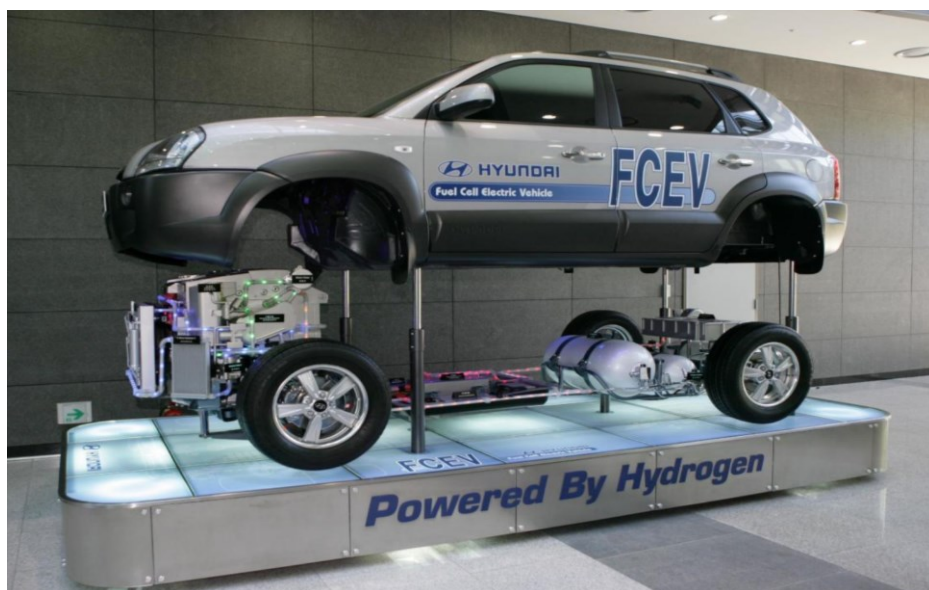
Bild 20 Fahrzeug mit Elektromotor-Antrieb und Elektroenergie-Erzeugung an Bord mittels Brennstoffzelle, mit den dafür erforderlichen Wasserstoffbehältern (Quelle: Hyundai)
