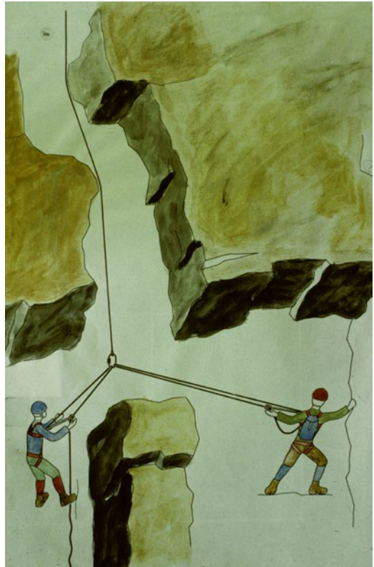
■ Abb. 23.5 Seilrollenprinzip am Stahlseil. (Zeichnung: Klaus Hoi)
