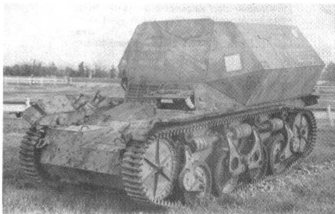
Der Panzerspähwagen AMR 34 wurde in geringen Stückzahlen zu einem Trägerfahrzeug für den 8-cm-schweren Granatwerfer 34 umgebaut.
