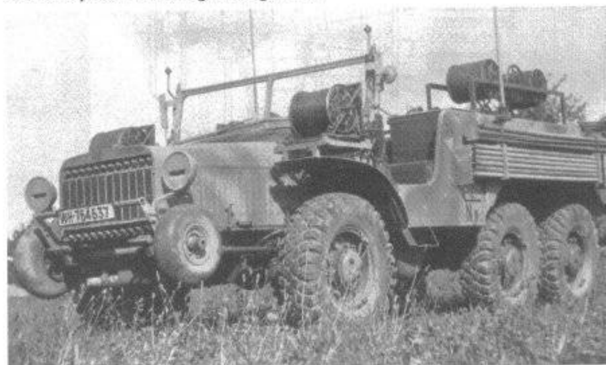
Für die Schnelle Brigade West wurden 24 Stück Laffly W 15 T als Fernsprech-Kraftwagen umgebaut.
