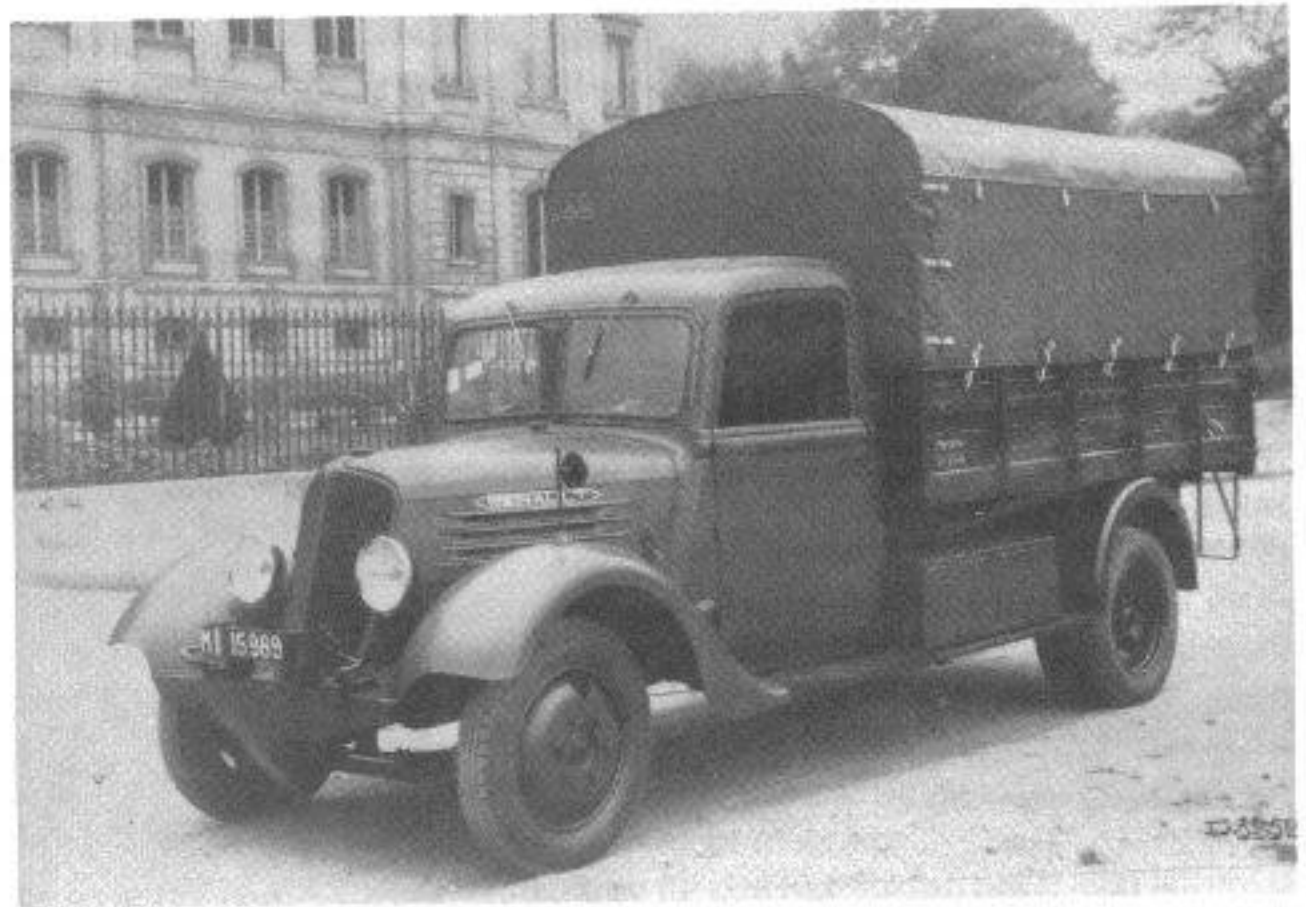
Lastkraftwagen 2 t der Firma Renault, Typ ADK vor der Übernahme durch deutsche Streitkräfte.
