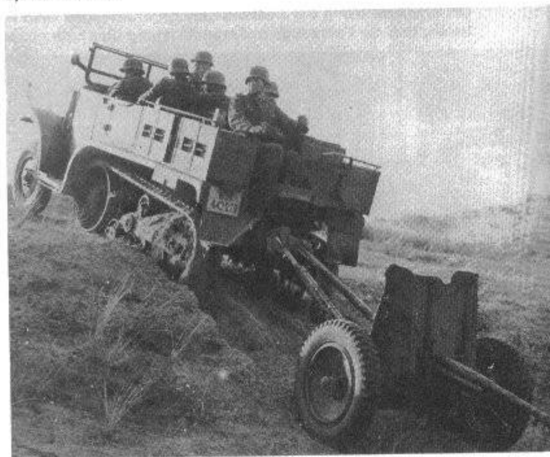
Umgebaute Zugmaschine Unic P 107 als Zugmittel für die 3,7-cm-Pak 36.
