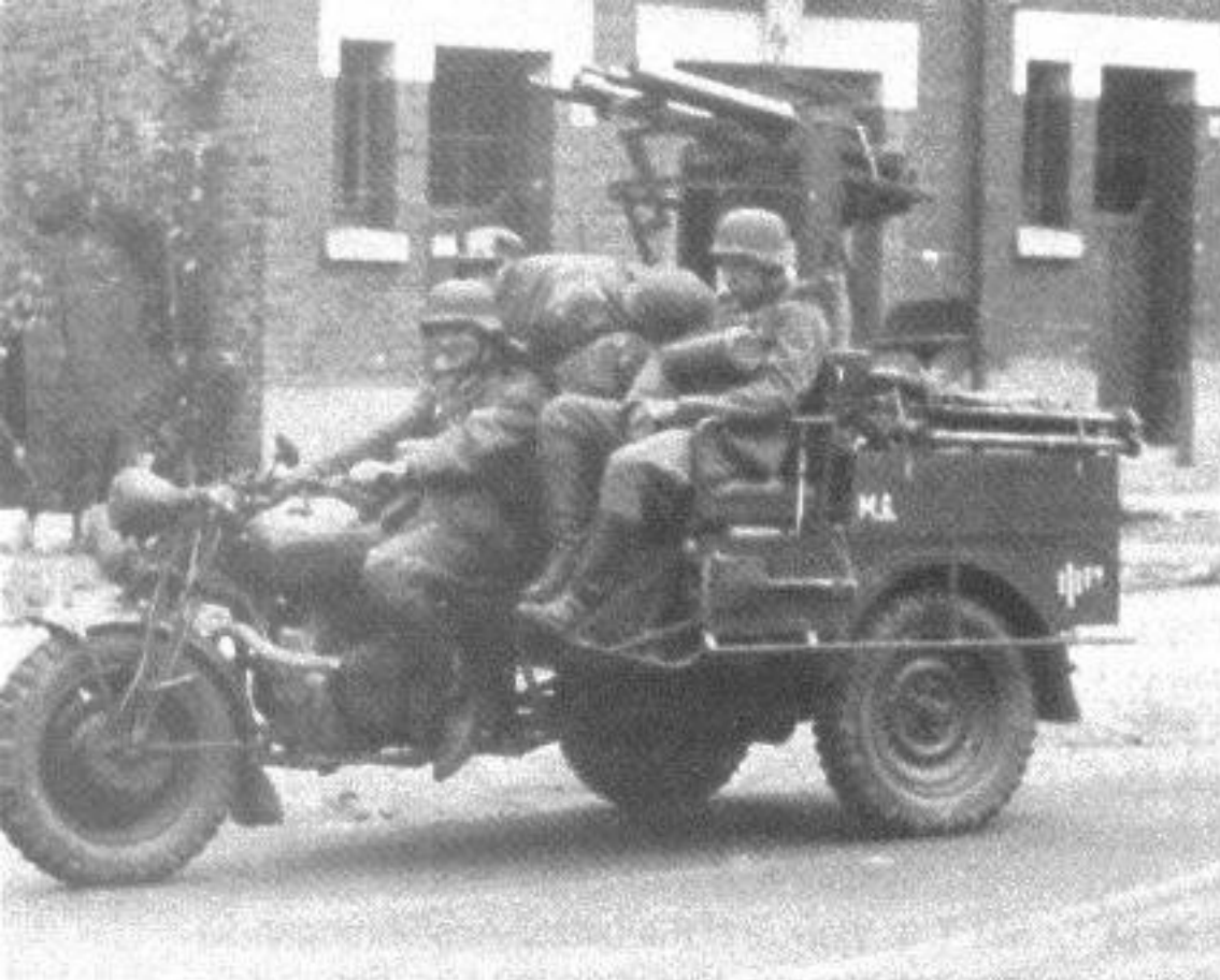
Mehrzweck-Dreirad, Typ M 12 SM T 3 der Firma FN. Hier Ausführung als Fliegerabwehrfahrzeug mit zwei MG. Bekannt als Tricar.
