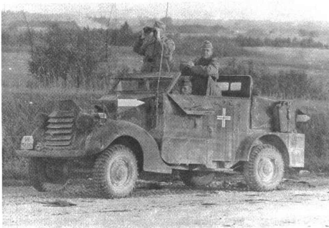
Eine Kleinserie von Ford 1 t Lastkraftwagen wurde mit Marmon-Herrington Vierradantrieb versehen und gepanzert. Sie dienten als Zugmittel für leichte Geschütze. Einige dieser Fahrzeuge blieben ungepanzert. Eines der gepanzerten Fahrzeuge lief als Kommandeurwagen bei der 8. Panzerdivision.
