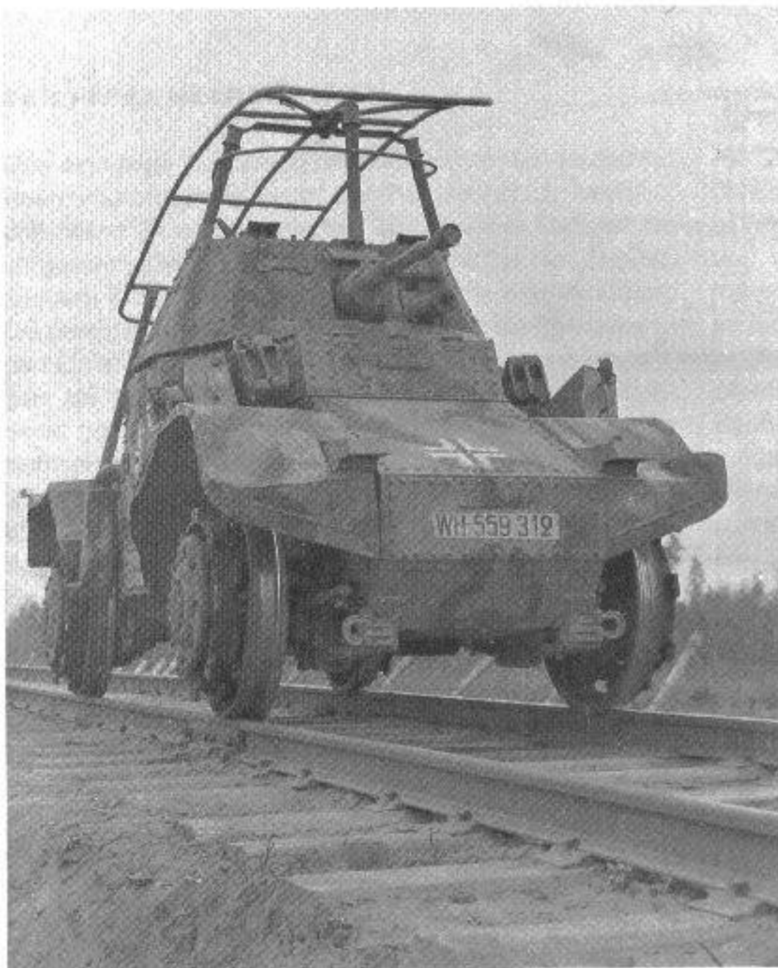
Panhard 178 mit Schienenausrüstung für den Einsatz als Panzerdrähsine. Alle Panhard-Panzerspähwagen erhielten bei Bedarf die typische deutsche Rahmenantenne.
