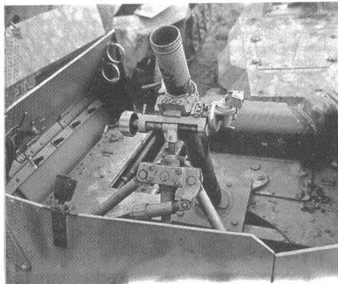
Der Einbau des 8-cm-Granatwerfers in der fest angeschraubten Bodenplatte. Die Standard-Bodenplatte war für den Einsatz des Werfers außerhalb des Fahrzeuges an Bord mitgeführt.
