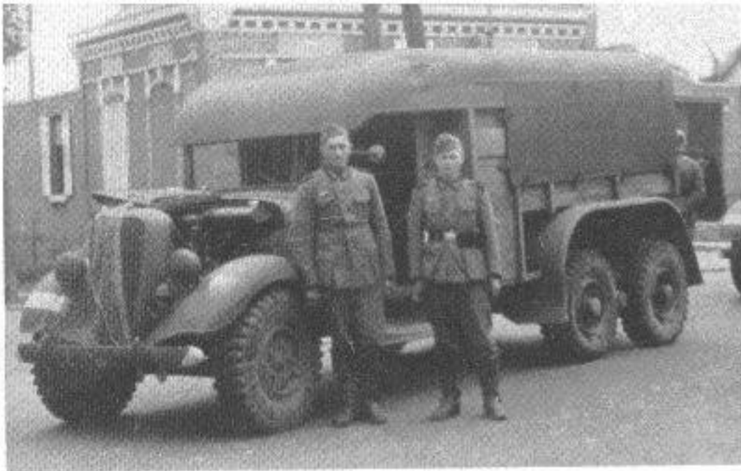
1937 Ford Lastkraftwagen, Typ 79, umgebaut mit TRADO als Artilleriezugmaschine.
