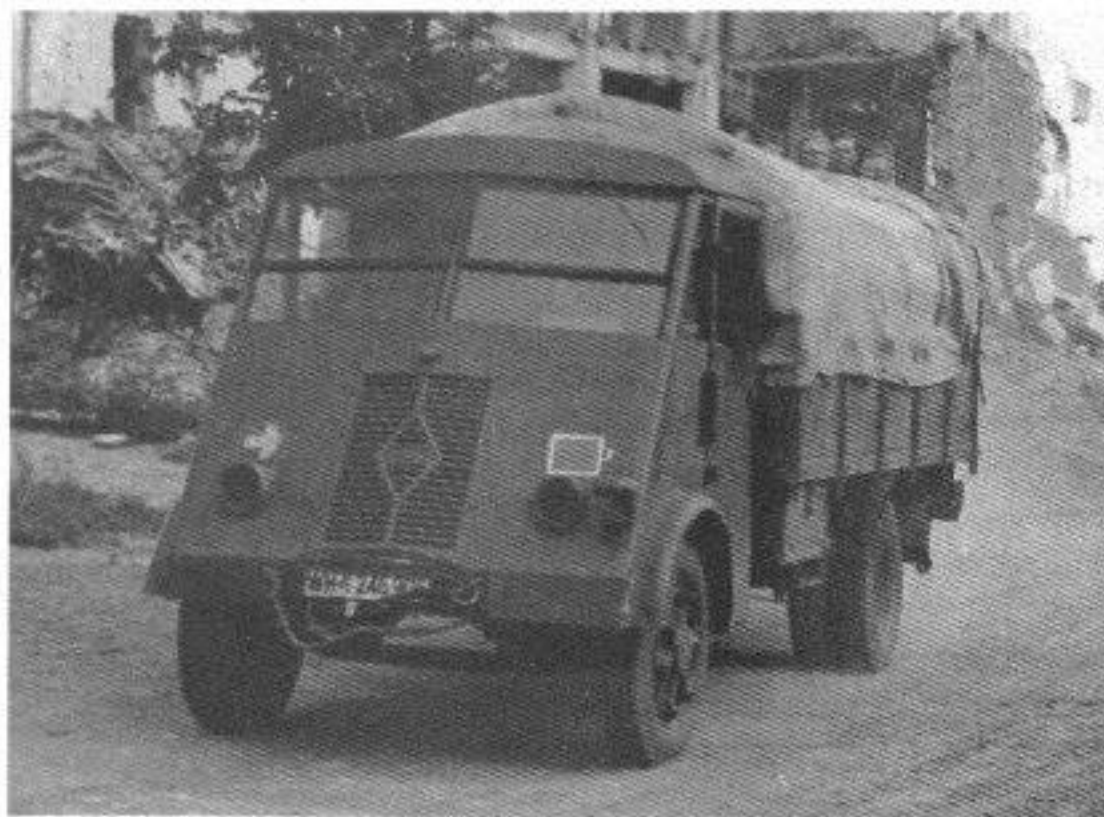
Die 3 t Ausführung der Firma Renault vom Typ AHN, von der mehrere Tausend an die Deutsche Wehrmacht geliefert wurden.
