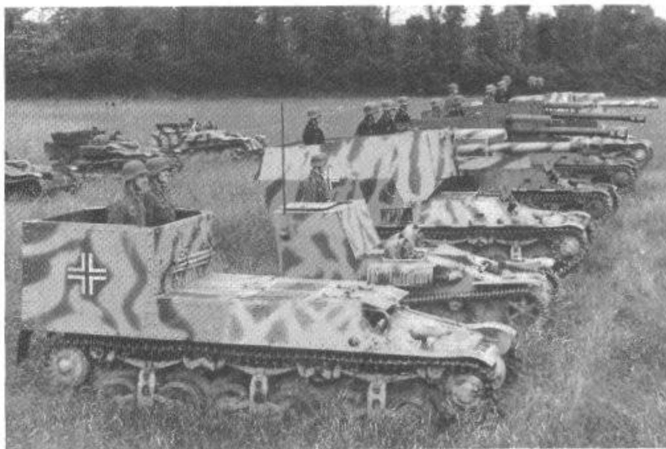
Ein VBCP als Beobachtungswagen bei einer 10,5-cm-Artillerie-Selbstfahrlafetten-Batterie, ebenfalls auf Lorraine-Fahrgestell. Neben dem VBCP ein umgebauter kleiner Beobachtungswagen auf Fahrgestell Renault UE.
