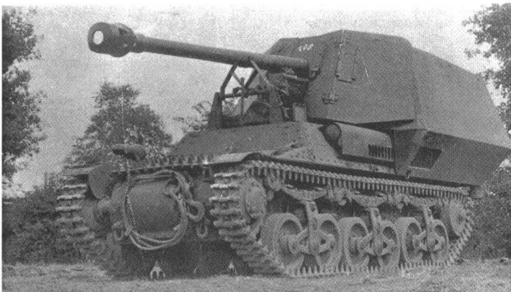
7,5-cm-Pak 40/1 auf Panzerjäger Lorraine-S (Sd. Kfz. 135). Das Rohr ist gezurrt.
