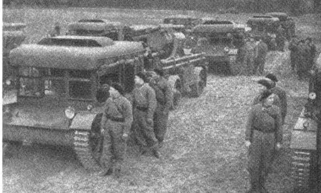
Auf der Basis VAU bzw. 7 TP entstand das Mörserzugmittel C 6 P bzw. C 7 P. Das Bild zeigt eine schwere Mörser-Batterie mit 220-mm-Škoda-Mörsern vor Kriegsausbruch.
