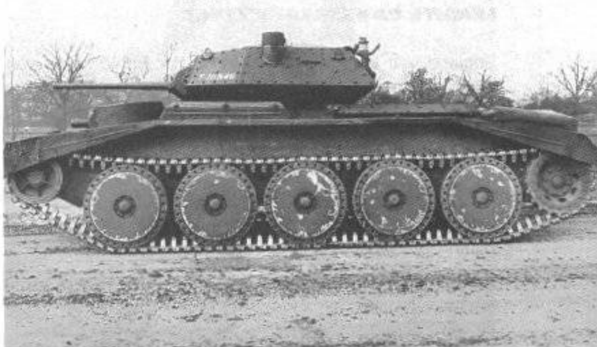
Kreuzer-Kampfwagen Mark VI »Crusader I«, Kenn-Nummer 746 (e). Die erste Ausführung führte links auf der oberen Bugplatte einen mit MG bestückten kleinen Turm.
