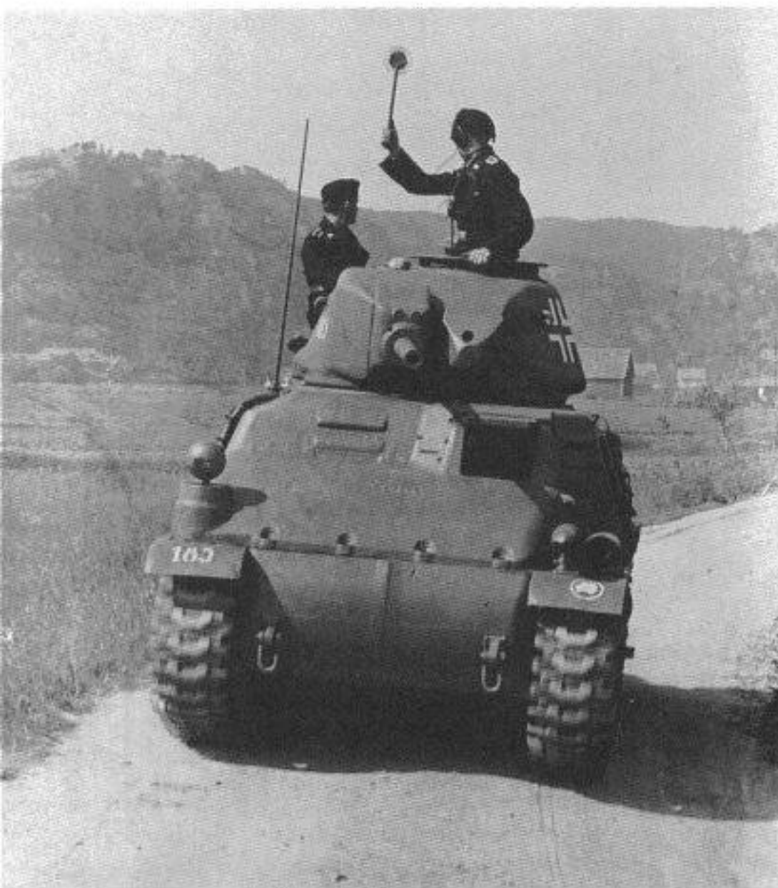
Teilweise wurden auch Kommandantenkuppeln des deutschen Panzerkampfwagen II aufgebaut.
