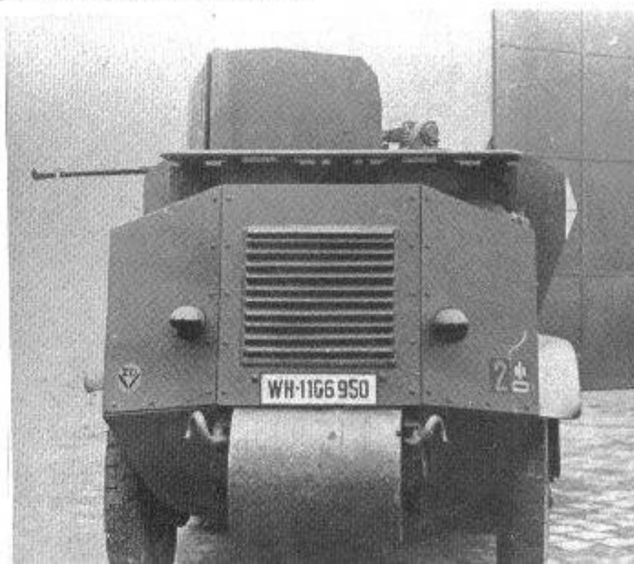
Die Vorderansicht der Selbstfahrlafette zeigt die Frontalpanzerung des Motorraums.
