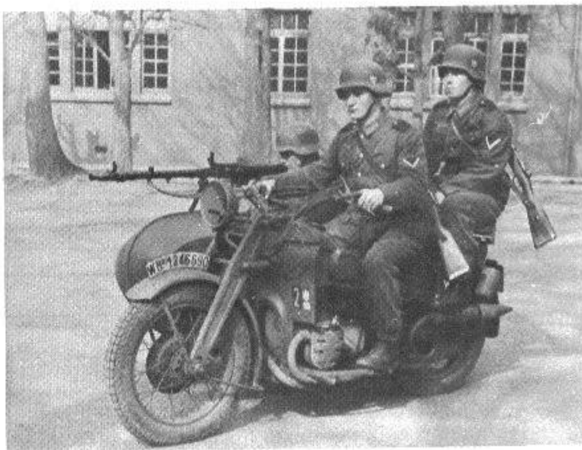
Unter den Fahrzeugen befanden sich auch 24 Gnome et Rhone Krafträder (800 cm 3 ) mit angetriebenen Seitenwagen.
