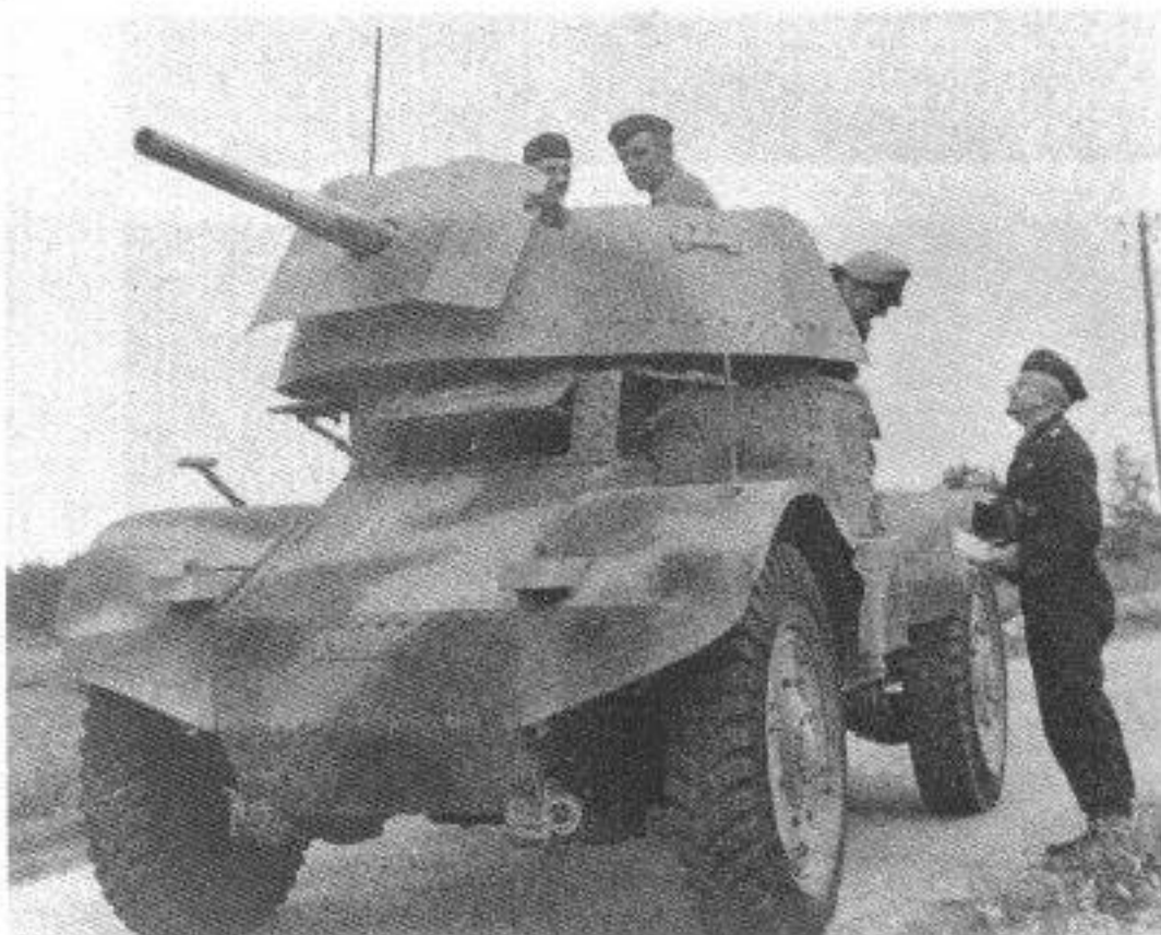
Die beiden Bilder zeigen den Panhard-Panzerspähwagen nach dem Umbau auf die deutsche 5-cm-Kampfwagenkanone L/42.
