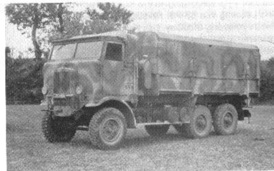
Lastkraftwagen 3 t, 6x4, Leyland Retriever. Windschutzscheiben und Fahrerhaustüren sind nicht Originalausführung, sondern deutsche Änderung. Etwa 120 Stück als Troßlastkraftwagen bei der Deutschen Wehrmacht.
