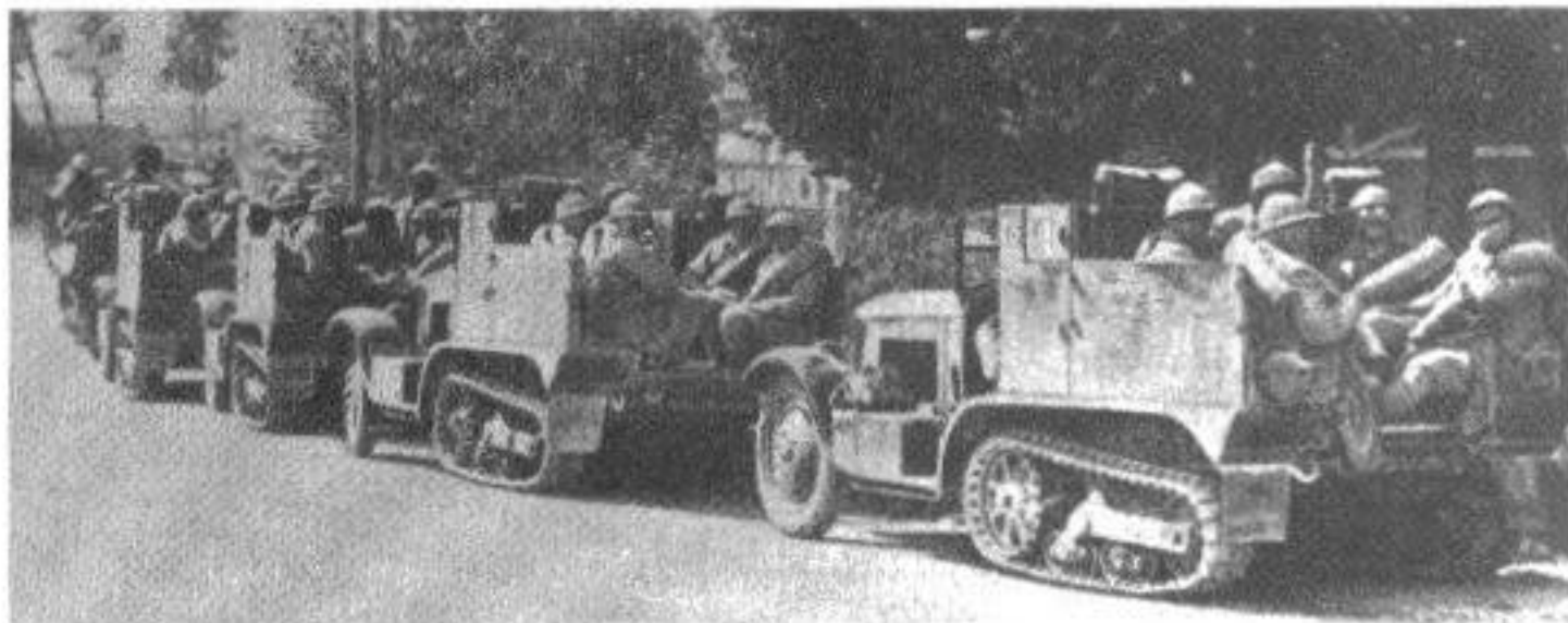
Der Citroën-Typ P 19 bildete die Grundlage für das Transportfahrzeug der motorisierten Dragoner. Die deutsche Kenn-Nummer lautete Transport-Kraftwagen Ci 380 (f).
