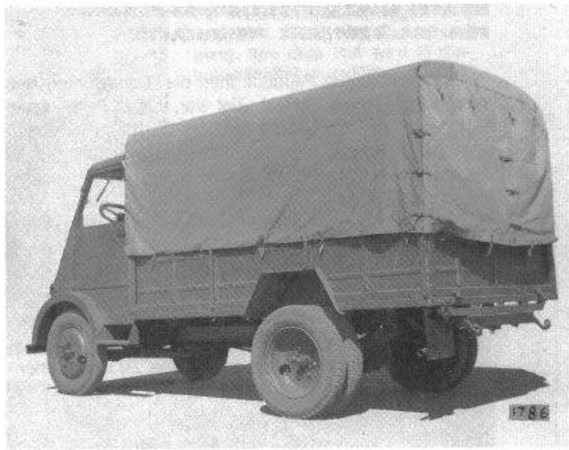
Der Peugeot Lastkraftwagen 2 t, Typ DMA, der in beträchtlichen Stückzahlen an die deutschen Streitkräfte geliefert wurde. Vor- und Rückansicht des handelsüblichen Fahrzeuges.
