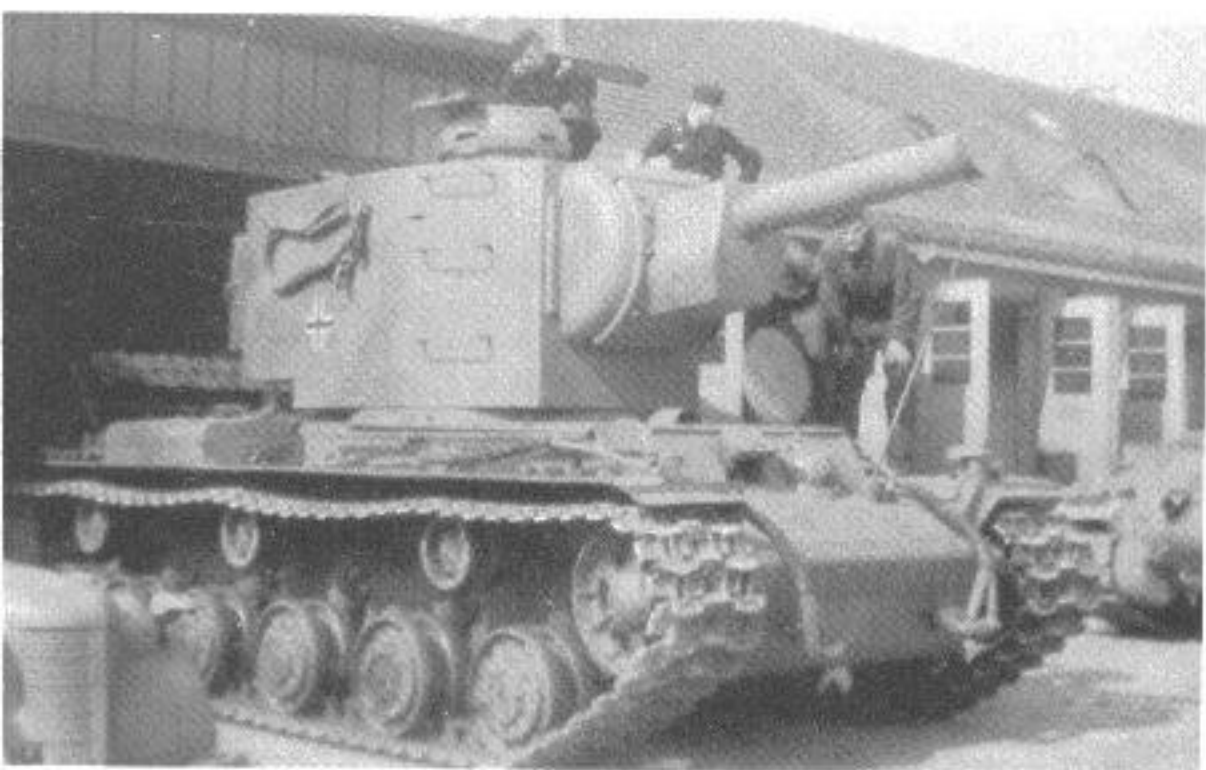
▲ Ein umgebauter KW I, der hier mit der 7,5-cm-Kampfwagenkanone L/43 des Panzer IV ausgerüstet ist.
