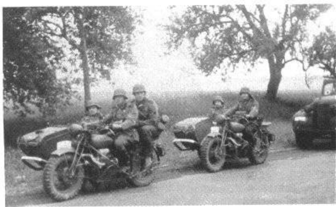
Schwere FN Typ M 12 (12a SM) Motorräder mit angetriebenem Seitenwagen. 992 cm 3 Boxermotor.
