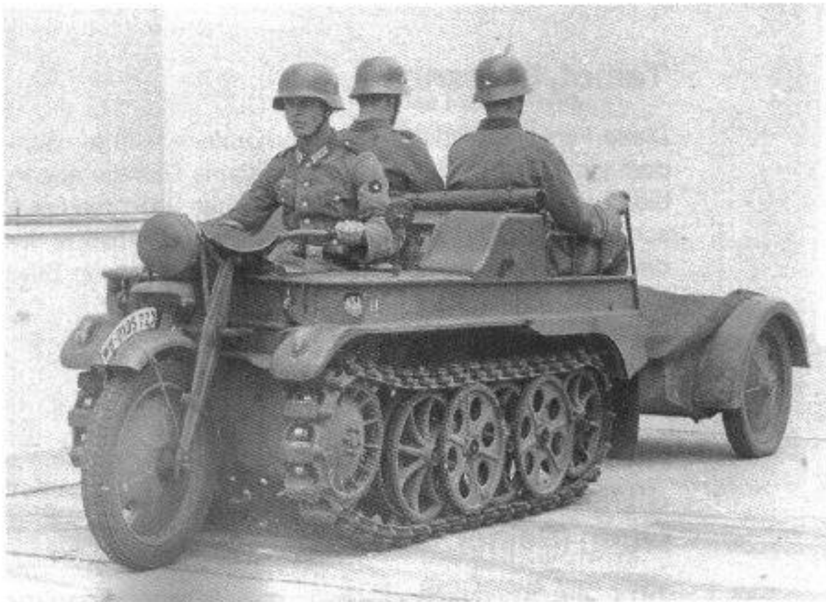
Das von NSU entwickelte Kettenrad, kleines Kettenkrafttrad (Sd. Kfz. 2) sollte von Simca nachgebaut werden. Das Bild zeigt die Vorderansicht des Fahrzeuges mit Anhänger.
