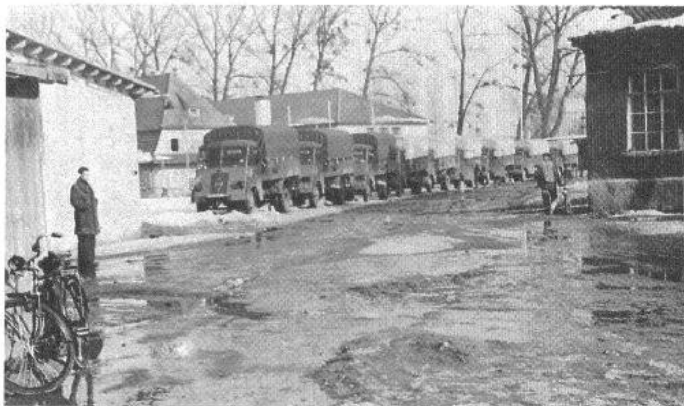
Aus der Kriegsproduktion der Firma Renault der Typ AHS 1 mit 2 t Nutz- last, irgendwo in Rußland.
