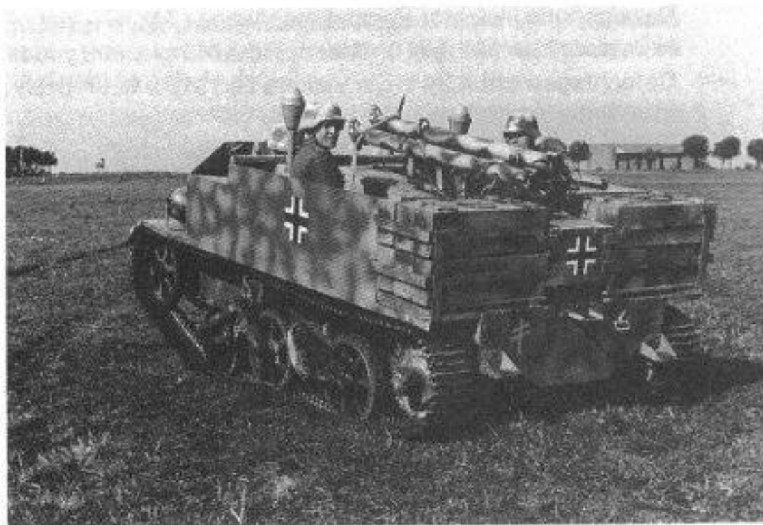
Vorder- und Rückansicht des Bren MG-Träger-Panzerjagdfahrzeuges mit Panzerschreck- und Panzerfaustausrüstung.
