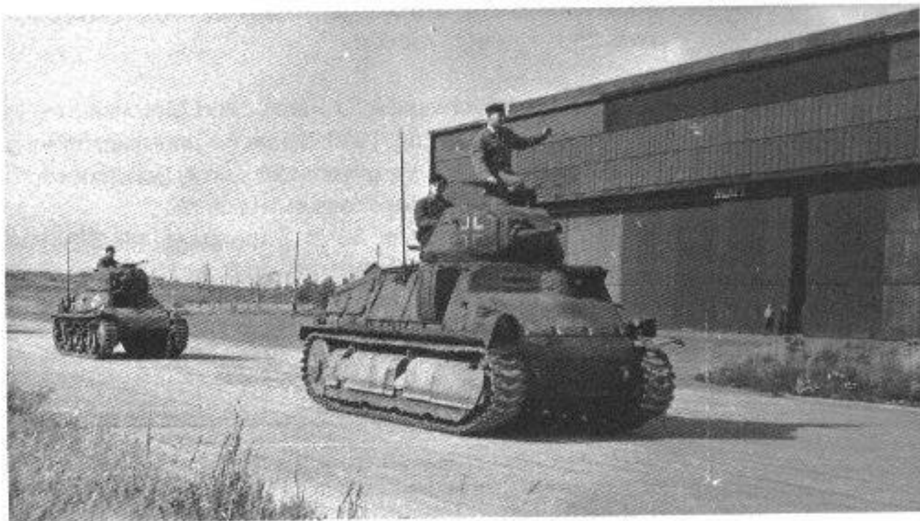
Panzerkampfwagen Somua 35 S (f) beim Einsatz bei der deutschen Panzertruppe. Die Beobachtungskuppeln auf den Drehtürmen wurden mit einem zweiteiligen Lukendeckel versehen, ein Umbau der auch bei anderen französischen Kampfpanzern stattfand.
