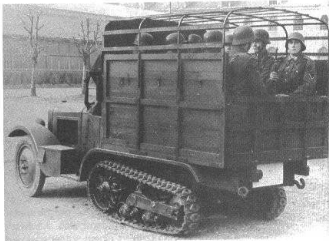
Vorder- und Rückansicht eines für die Deutsche Wehrmacht wieder hergerichteten Mannschafts-Transportfahrzeuges (ungepanzert), Typ Citroen P 19.
