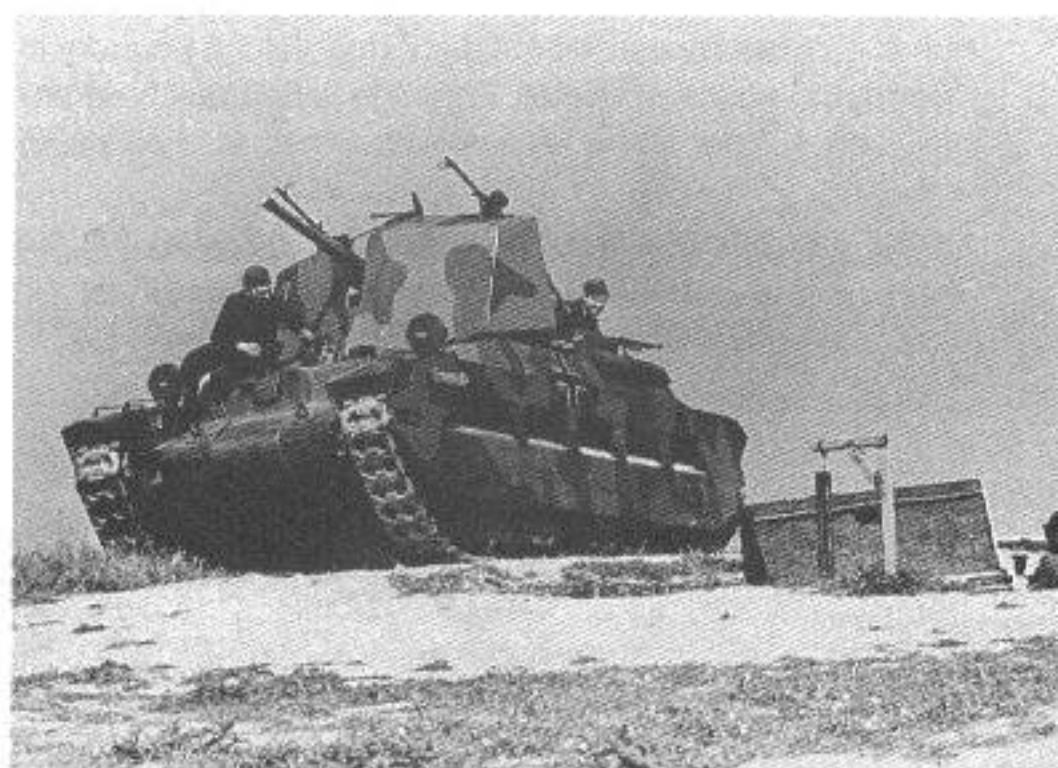
Beide Aufnahmen zeigen einen von der deutschen Truppe umgebauten Infanterie-Kampfpanzer Mk II. Anstelle des Drehturms wurde hinter Schutzschild eine 5-cm-KwK L/42 geführt. Übungen an der Küste Frankreichs.
