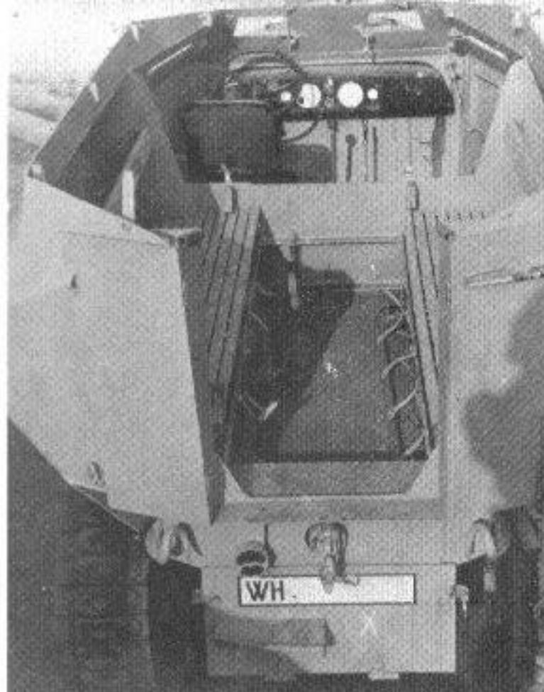
Blick in das Innere des leichten Schützenpanzerwagens Unic P 107.
