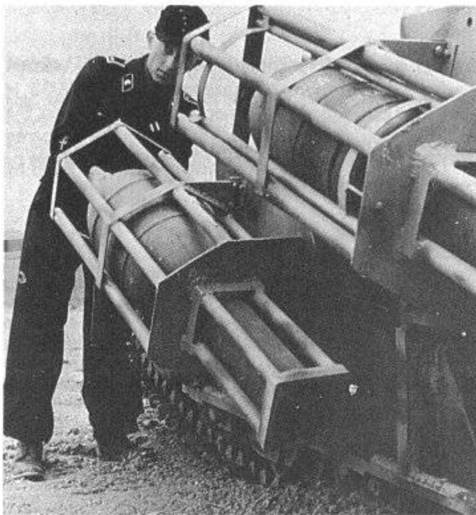
Einzelheiten der seitlich am Fahrzeug montierten Wurfrahmen.
