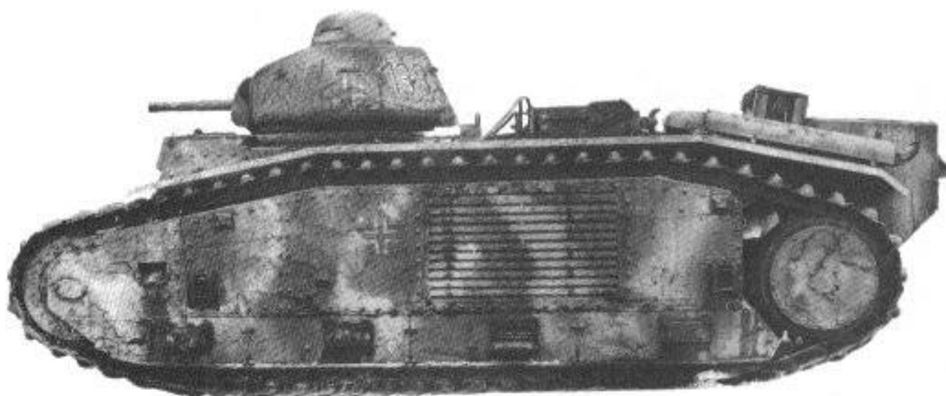
Die Seitenansicht des Flammenwerferpanzers zeigt den hinten am Fahrzeugheck angebrachten Behälter für das Flammöl.
