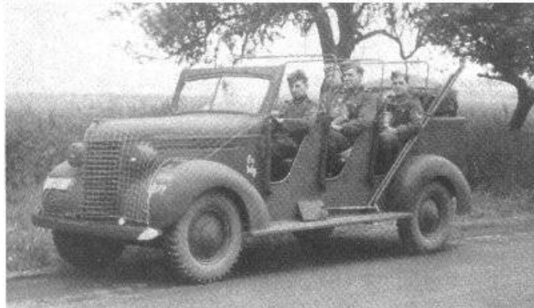
1939 Chevrolet Personenkraftwagen mit DAF-Aufbau. Ausrüstung als Fernsprechwagen für die Deutsche Wehrmacht.
