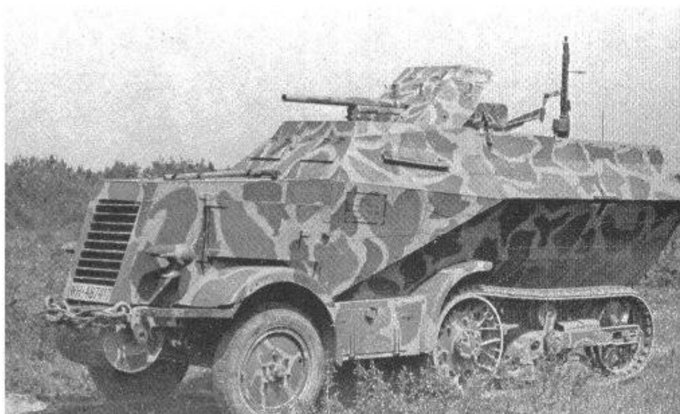
Die Zugführerfahrzeuge waren mit der 3,7-cm-Pak 36 ausgerüstet.
