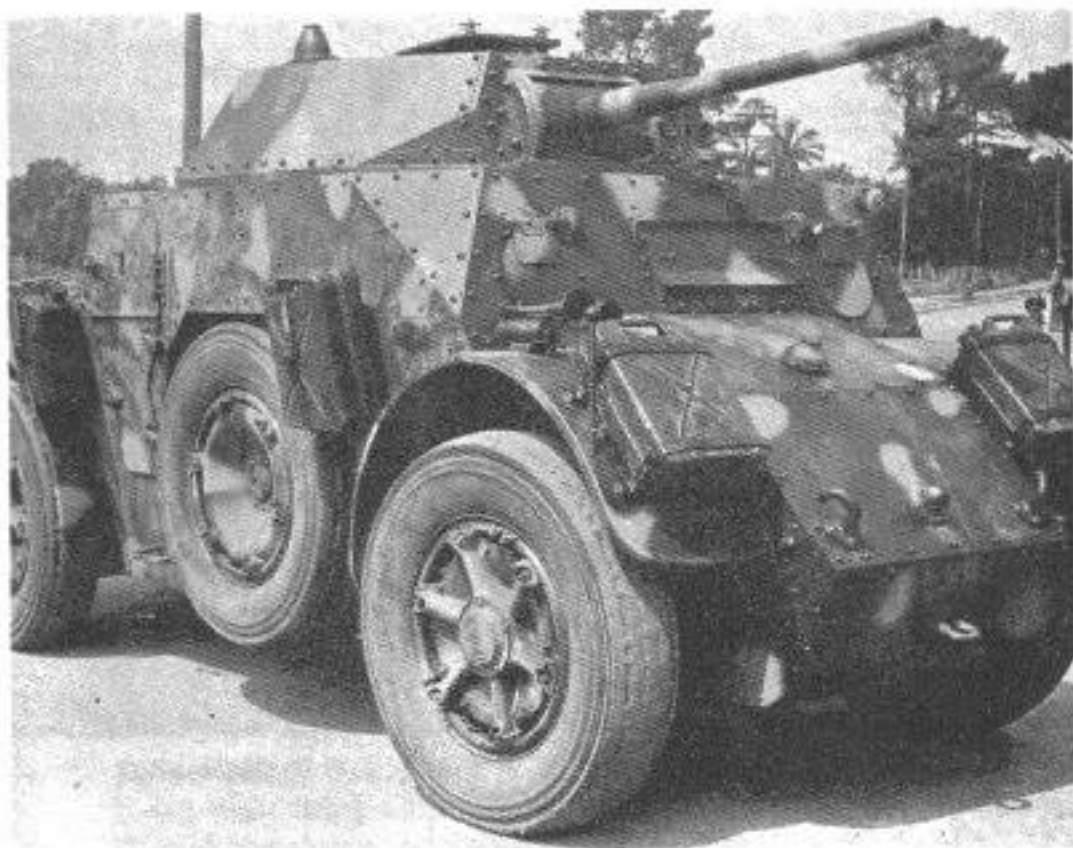
Panzerspähwagen Fiat/SPA, Typ AB 43 (i) mit 4,7-cm-Kanone im Drehturm.
