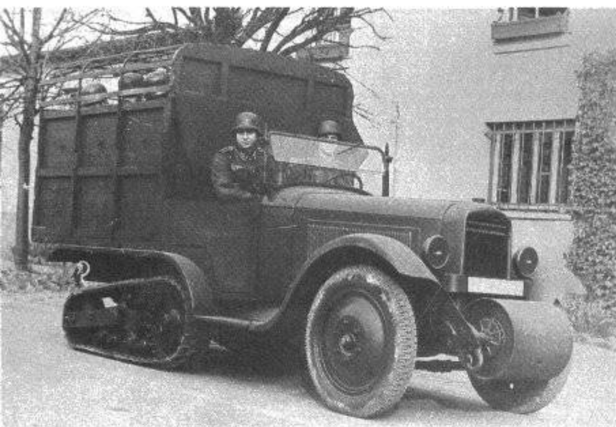
Vorder- und Rückansicht eines für die Deutsche Wehrmacht wieder hergerichteten Mannschafts-Transportfahrzeuges (ungepanzert), Typ Citroen P 19.
