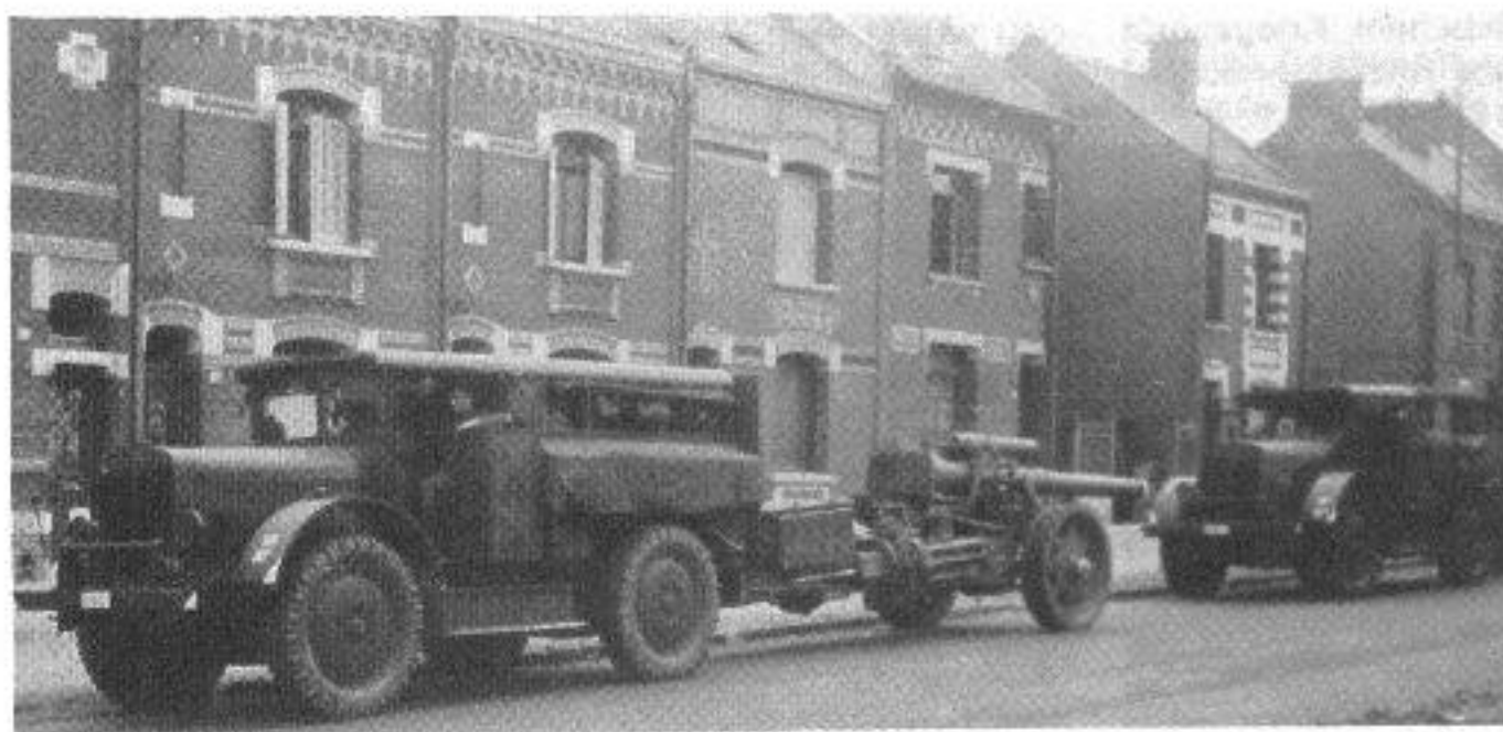
Und so verläßt seine Batterie nach schweren Kämpfen Belgien nach einigen Wochen. Seine Einheit hat er motorisiert mit Beutefahrzeugen. Die Haubitzen werden von belgischen Artillerie-Radschleppern, Typ TAL der Firma Gebr. Brossel, gezogen. Die Protzen hatte man zurückgelassen, die Räder der Geschütze auf mot-Zug umgestellt.
