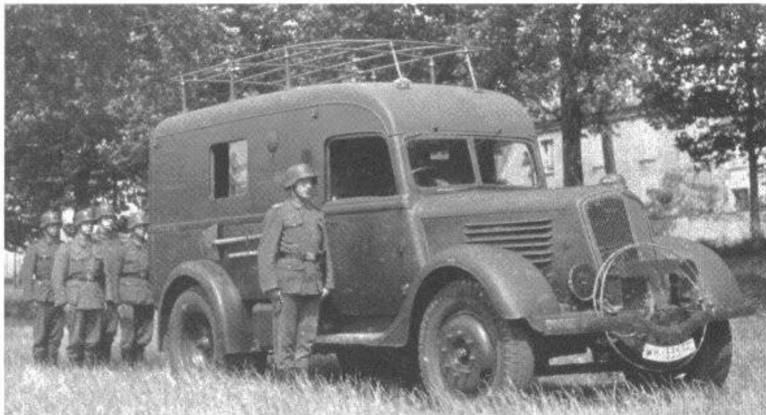
Der Lastkraftwagen ADH 1 von Renault, der schon bei der französischen Armee als Funkwagen verwendet wurde, lief auch bei der Schnellen Brigade West mit 24 Stück.
