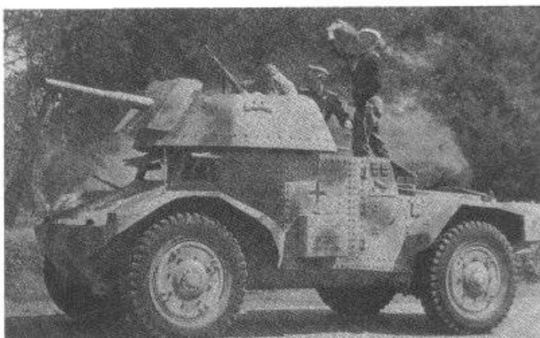
Die beiden Bilder zeigen den Panhard-Panzerspähwagen nach dem Umbau auf die deutsche 5-cm-Kampfwagenkanone L/42.
