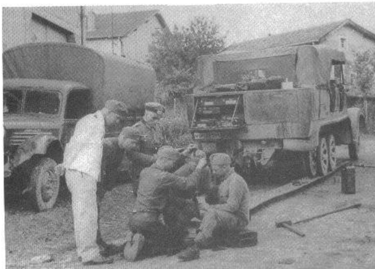
Lastkraftwagen 2 t, Typ ADK bei einer deutschen Instandsetzungseinheit. Ein Zugkraftwagen 8 t, Typ KM m 10 wird repariert.
