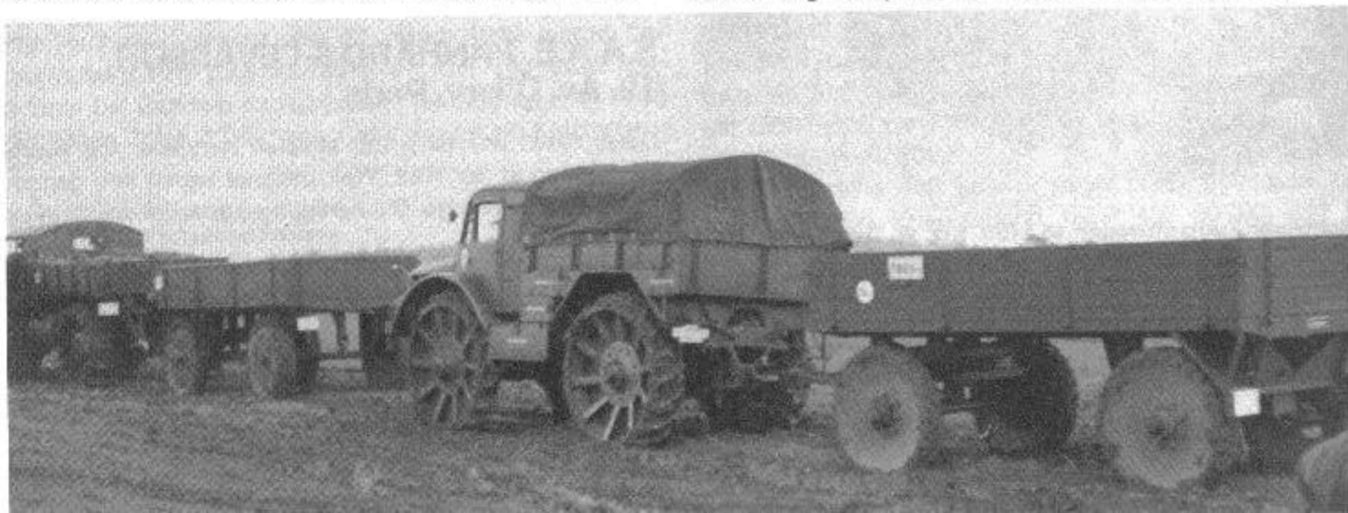
Unten: Vergleichsfahrt der RADSCHLEPPER OST, Ausführung Latil (links) und Porsche (Porschetyp 175).
