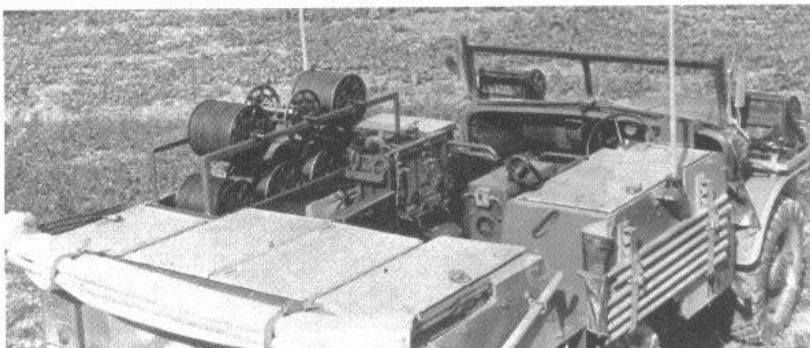
Dieses Foto zeigt den Einbau von Funkgeräten und Kabelrollen im Laffly W 15 T.
